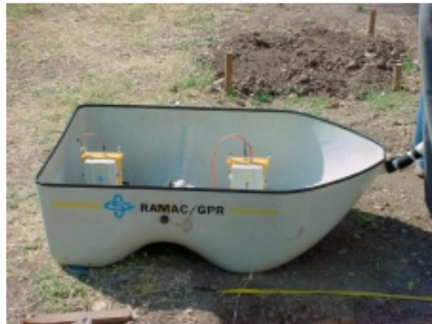
Figura 1. Carrinho para arraste do conjunto de antenas do GPR.
